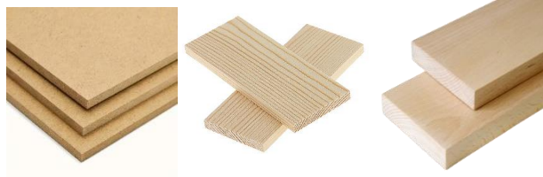
انواع الاخشاب التي يمكن استخدامها في المشروع يمين حشب ابيض - وسط حشب زان - يسار حشب M.D.F
